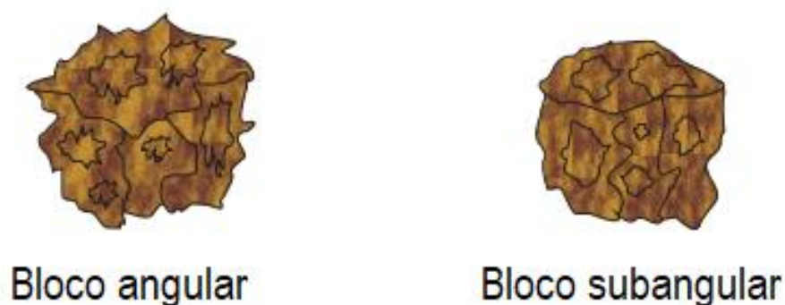
Figura 3: Estrutura angular e subangular.
